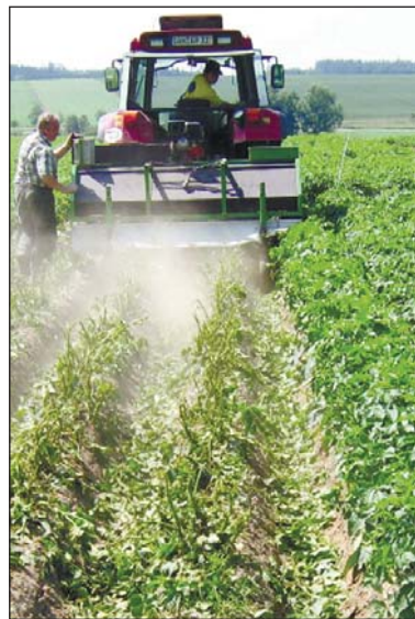
Der Hagelsimulator zerstört im Versuch die Kartoffeln in unterschiedlichem Ausmaß und zu verschiedenen Zeiten. Foto: Fischer
